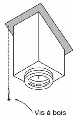
**Option 3 – Support de plafond carré isolé.** Pour une installation avec un appareil nécessitant une cheminée de 6 pouces (150 mm), dans une maison ayant des solives espacées de 12 pouces, il est possible d'utiliser un support de plafond carré isolé. L'installation se fait de la même façon qu'un support de plafond carré long, non isolé. Fixez le collet de finition en utilisant les vis fournies avec le collet.
