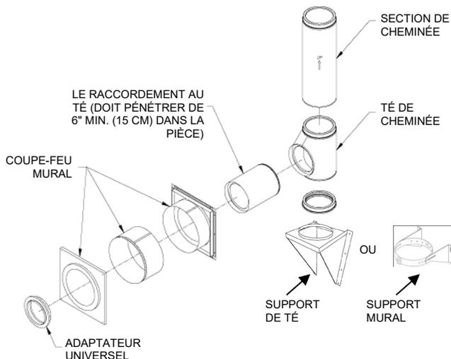
**Étape 3- Installation du coupe-feu mural :** Ce coupe-feu est constitué de 3 parties : la section extérieure du coupe-feu, l'extension réglable, et la plaque de finition intérieure. Installez la section coupe-feu sur le mur extérieur avec la section du tuyau qui pointe vers la structure intérieure. Il est recommandé de sceller les bords extérieurs de la section coupe-feu avec un scellant hydrofuge à base de silicone.
