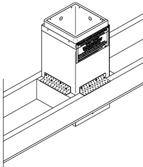
**Étape 3- Installation du coupe-feu de grenier :** Le coupe-feu de grenier sert à conserver le dégagement (espace d'air) requis de 2 pouces (5 cm) de l'isolant, du câblage électrique et des matériaux lorsque la cheminée traverse le grenier. Trois options différentes permettent de réaliser cette étape clé :
