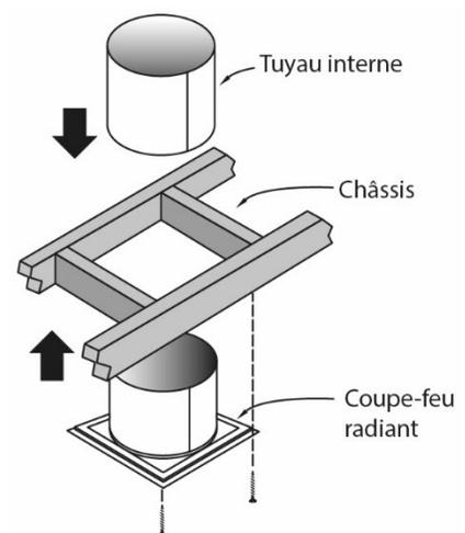
**Option 2 – Support de plafond carré isolé.** Pour une installation avec un appareil nécessitant une cheminée de 6 pouces (150 mm), dans une maison ayant des solives espacées de 12 pouces, il est possible d'utiliser un support de plafond carré isolé. L'installation se fait de la même façon qu'un support de plafond carré long, non isolé.
