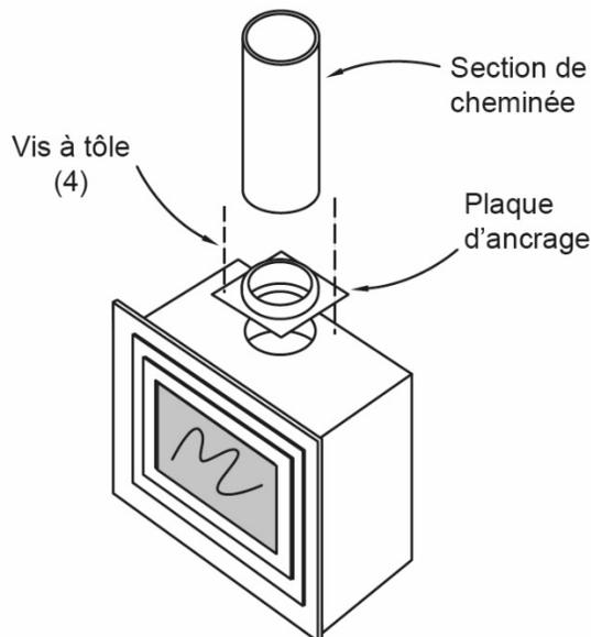
Installez le système de cheminée 2100 uniquement avec des foyers préfabriqués ou avec des foyers à dégagement zéro, approuvant son utilisation. **Assurez-vous de lire et de suivre soigneusement les instructions d'installation du fabricant.**
