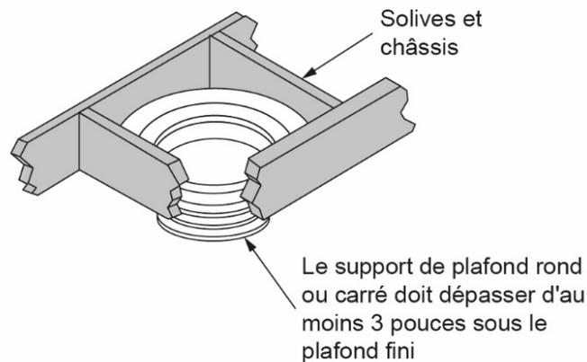
**Option 2 – Support de plafond carré ou rond (long).** Peut être utilisé pour un plafond cathédrale, mais aussi pour un plafond plat. Placez le support de plafond dans l'ouverture brute et fixez-le au châssis en utilisant au moins 3 clous n° 8d ou 3 vis à bois n° 8 x 1 ½" par côté (au moins 12 clous au total). **La partie la plus basse du support doit dépasser de 3 pouces (75 mm) ou plus sous le plafond fini.** Fixez le collet de finition en utilisant les vis fournies avec le collet.
