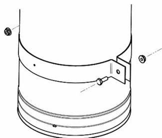
Mesurez la distance nécessaire entre la dernière section de cheminée et le support de plafond isolé afin d'installer la bride de serrage sur la section de cheminée au bon endroit. Pour une installation plus facile, une section de cheminée télescopique peut aussi être utilisée.
