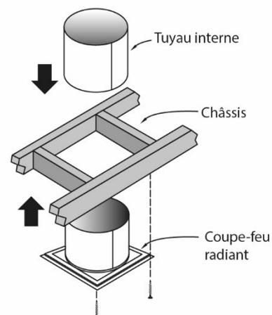
**Option 2 – Support de plafond carré isolé.** Pour une installation avec un appareil nécessitant une cheminée de 6 pouces (150 mm), dans une maison ayant des solives espacées de 12 pouces, il est possible d'utiliser un support de plafond carré isolé. L'installation se fait de la même façon qu'un support de plafond cathédrale non isolé. Fixez le collet de finition en utilisant les vis fournies avec le collet.
