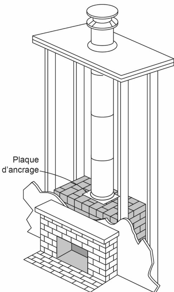
**Étape 1-** Pour trouver le bon diamètre de conduit pour un foyer de maçonnerie, souvenez-vous que la surface de la section transversale de la cheminée (diamètre intérieur) doit être équivalente au minimum à 1/12<sup>e</sup> de la surface de l'ouverture du foyer.
