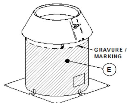
**NOTE :** Il est interdit d'installer un coupe-feu de grenier isolé dans un espace habité (incluant un placard et un grenier habité). Pour ce type d'installation, utilisez plutôt un coupe-feu radiant (option 1).
