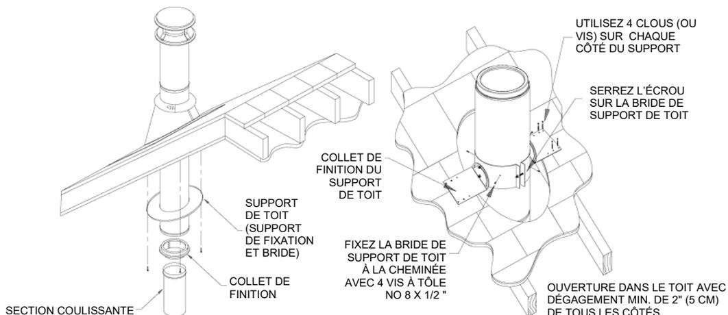
Les installations avec un support sur le toit sont populaires dans les habitations de type chalet (en forme de A). Généralement, deux installations sont alors possibles. La première utilise un support de plafond cathédrale carré ou rond et la seconde fait appel simplement à un support de fixation au toit.
