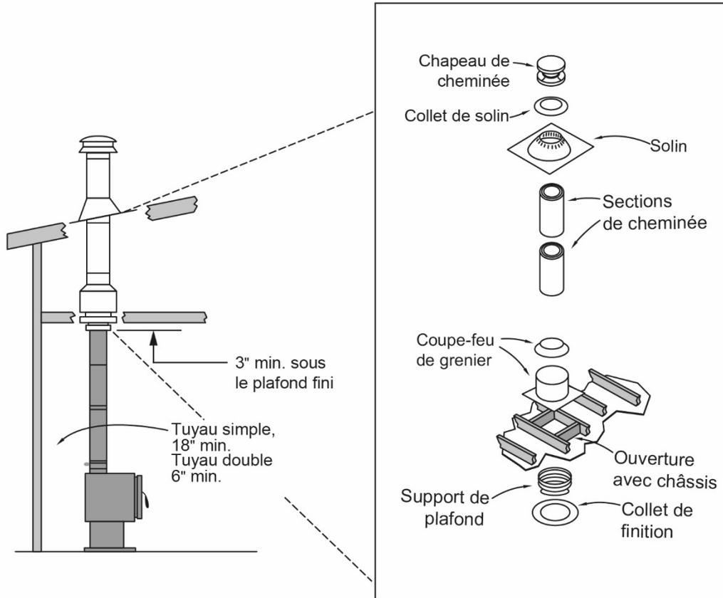
**Étape 1- Installation de l'appareil :** Placez l'appareil à l'endroit désiré conformément aux instructions du fabricant et aux spécifications en matière de dégagement. Accordez une attention particulière à la buse d'évacuation de l'appareil et veillez à la centrer entre les chevrons et les solives au-dessus.
