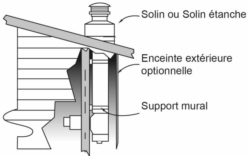
On fait appel à une installation avec support à l'extérieur lorsque la cheminée traverse un espace habité vers une cheminée extérieure. L'installation avec support à l'extérieur utilise un système de support de fixation murale sécuritaire assurant un support d'appui latéral et vertical.
