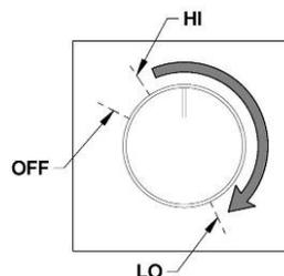
Puisque le ventilateur de l'encastrable est muni d'un capteur thermique, lorsque celui-ci est actionné, il se mettra en fonction automatiquement lorsque l'encastrable sera chaud et s'arrêtera lorsque l'encastrable aura refroidi. Par conséquent, vous pouvez laisser le contrôle de vitesse variable à la vitesse désirée.
