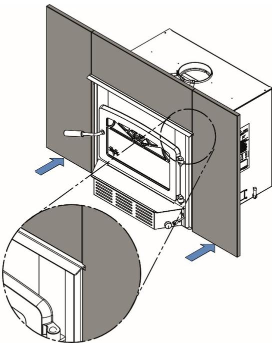
Une fois la façade assemblée, alignez les encoches, situées dans le haut de chaque côté de l'ouverture de la façade, avec le dessus de l'encastrable et poussez la façade vers le devant du foyer.
