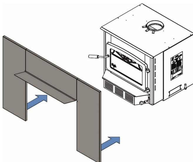
Une fois l'écran coupe-chaaleur installé, installez la façade sur l'encastable (voir **Annexe 3 : Installation de la façade**).
