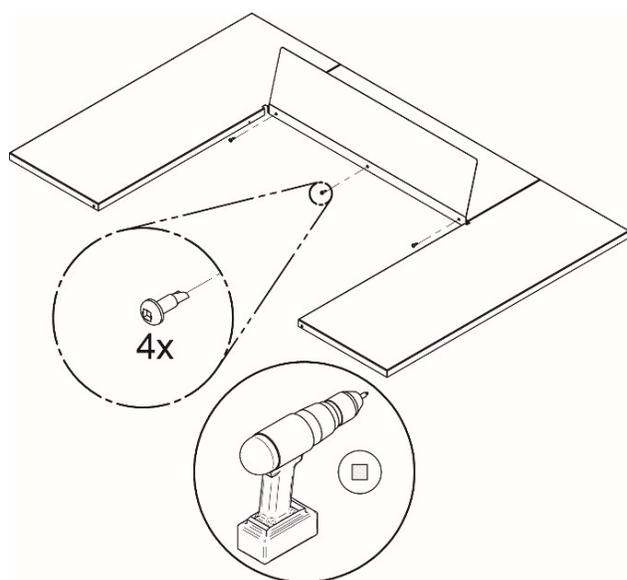
Installez l'écran coupe-chaaleur sur la façade à l'aide de 3 vis auto-taraudeuses comprises dans le kit. L'écran coupe-chaaleur doit pointer vers le haut.
