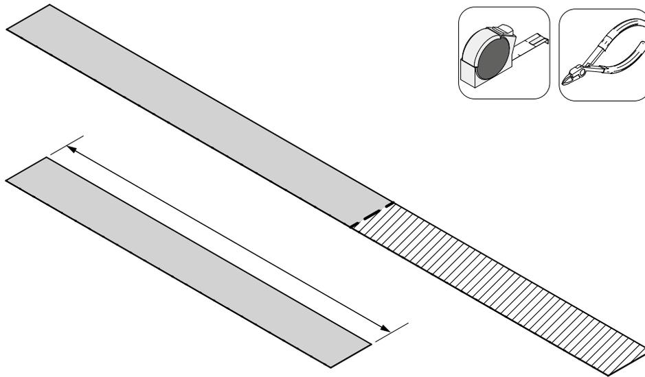
**Note :** En assumant que la tablette est centrée avec le foyer, il ne doit pas y avoir de support 8" de chaque côté à partir du centre de la tablette (zone hachurée). / **Assuming that the shelf is centered with the fireplace, there should be no support 8" on each side from the center of the shelf (hatched area).**
