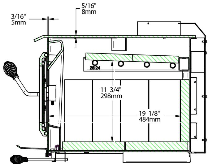
Figure 6: Vue de côté - chambre à combustion
