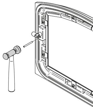
Figure 16: Installation de la goupille de retenue
