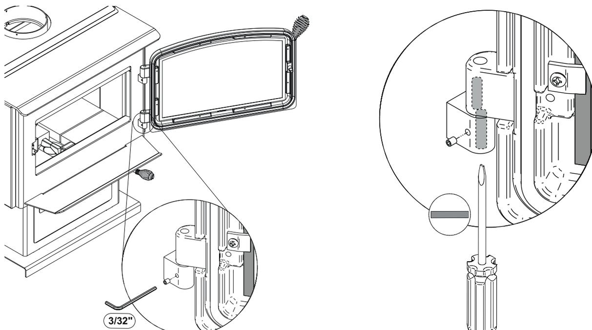
À l'aide d'un tournevis plat, tourner les tiges de pentures ajustables dans les sens indiqués pour ajuster les portes. Resserrez toutes les vis de pression sur les gonds de portes lorsque ces
